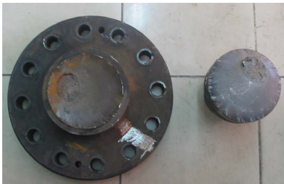
شکل ۱- تصویر ظاهری شفت شکسته
